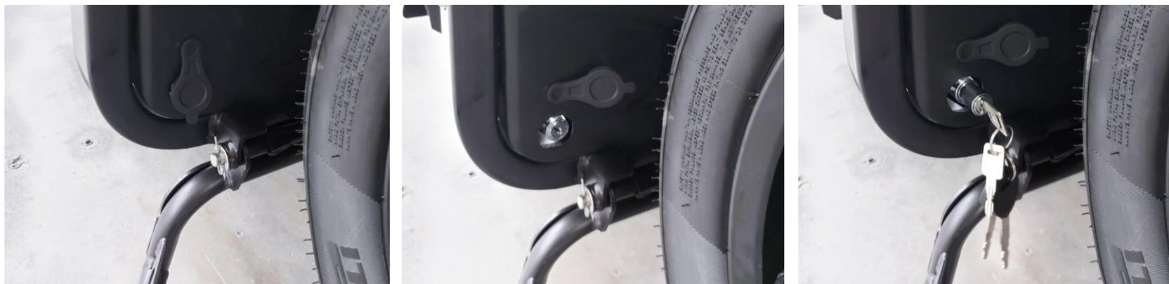
**WICHTIG:** Achten Sie darauf, das Batterie-Pack nicht zu entfernen oder einzusetzen, wenn das Motorrad aufgeladen wird oder wenn der Kontakt betätigt ist. Achten Sie darauf, **den Griff nicht vor dem Herausziehen des Packs auszuklappen** (klappen Sie ihn aus, sobald die Batterie aus dem Motorrad entfernt ist).
