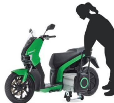
Setzen Sie das Batterie-Pack wieder in den Roller ein
