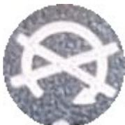
Alle Funktionen sind deaktiviert, das Lenkerschloss ist nicht eingerastet (der Roller kann bewegt werden). Das Arbeiten am Motorrad ist ohne Risiko möglich (es wird in jedem Fall empfohlen, die Schlüssel abzuziehen).
