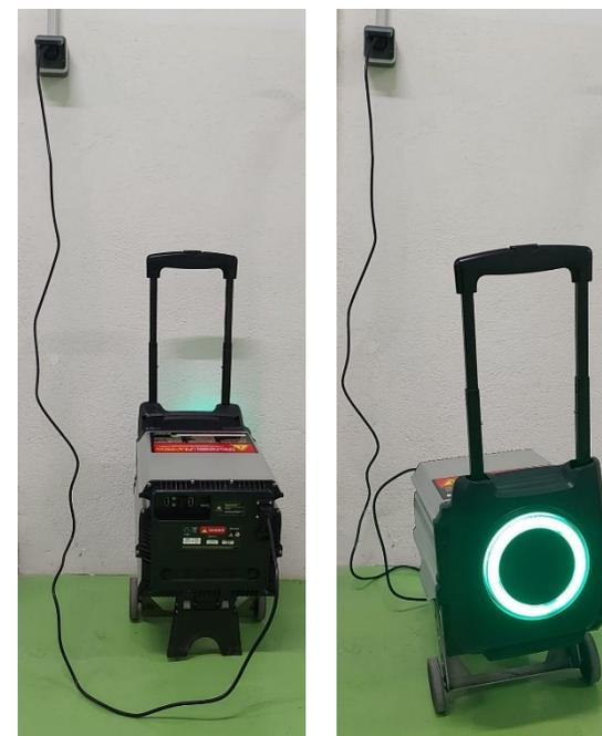
Vergewissern Sie sich vor dem Einsetzen oder Herausnehmen des Batterie-Packs, dass das Motorrad nicht geladen wird oder der Kontakt nicht betätigt ist.
