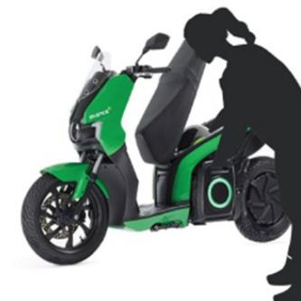
Vergewissern Sie sich, dass die Batterie korrekt eingrastet ist
