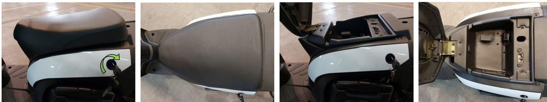
Unter dem Sitz befindet sich eine kleine Gepäckablage (~3 l), in der folgende (nachstehend beschriebene) Elemente untergebracht sind:
